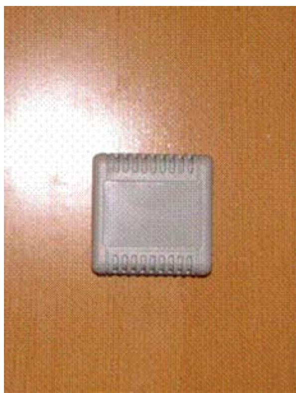
Figura 7.2. Instalación realizada para la monitorización del C-DdI CIESOL. Sensor de temperatura de aire interior.
