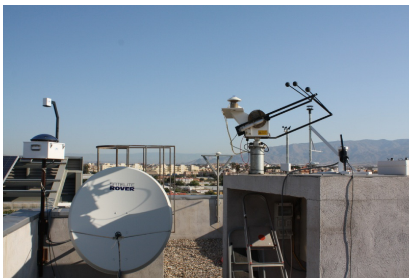
Fig. 4.3.14. Garita meteorológica: camera de nubes y antena parabólica encargada de establecer comunicación con el satélite geoestacionario Meteosat de Segunda Generación.
