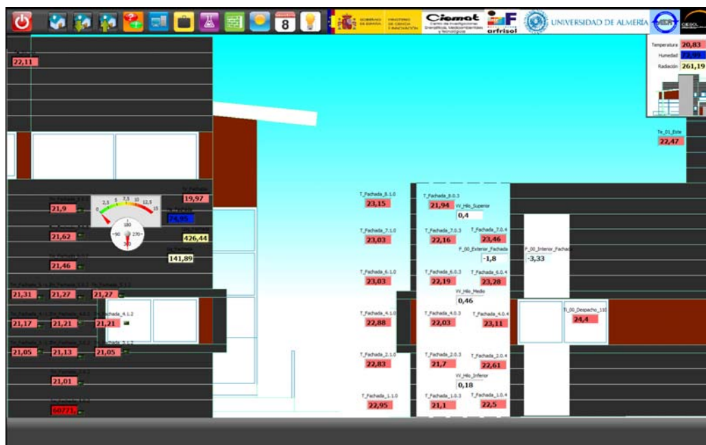
Fig. 3.16. Pantalla de control de temperatura interior y exterior de la fachada ventilada del edificio CIESOL.
