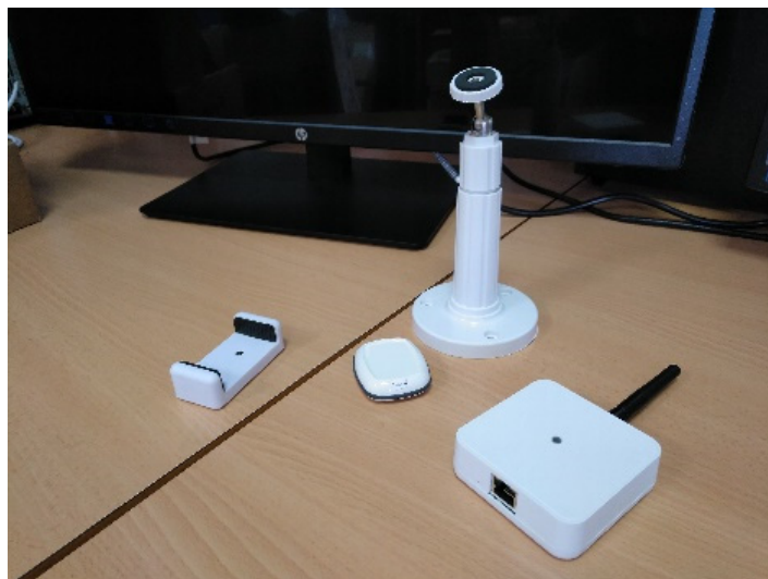
Baliza con soportes y sensor de localización.
