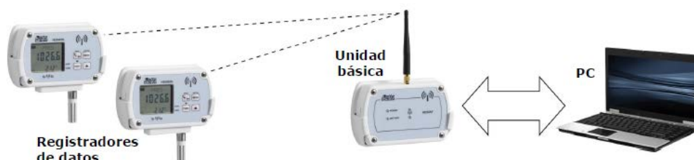
Esquema genérico de unidad base conectada entre registradores de datos y PC.
