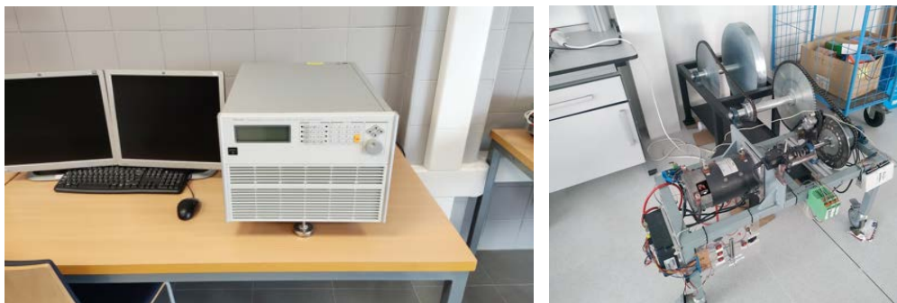
Simulador de carga (izquierda). Banco de carga para vehículo eléctrico (derecha)
