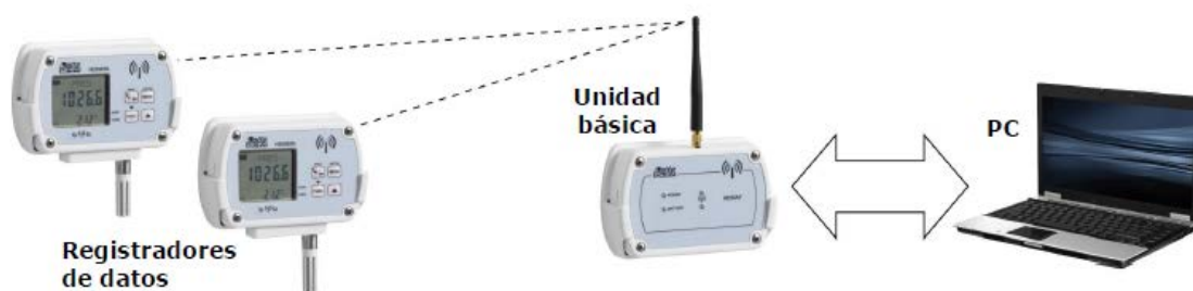
Esquema genérico de unidad base conectada entre registradores de datos y PC.
